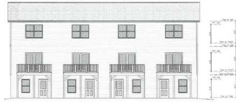
REAR ELEVATION SCALE: 1/8" = 1'-0"
